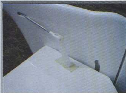
Le stab monobloc est commandé par un guignol extérieur, classique chez Scorpio.
