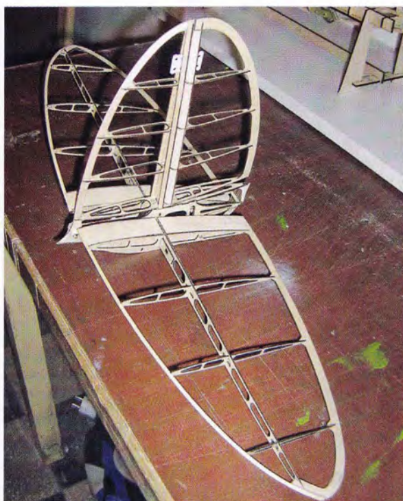
Das Höhenleitwerk ist als Pendelleitwerk ausgeführt. Die Anlenkungen sind weitgehend versteckt – die Oldtimeroptik wird nicht beeinträchtigt.
