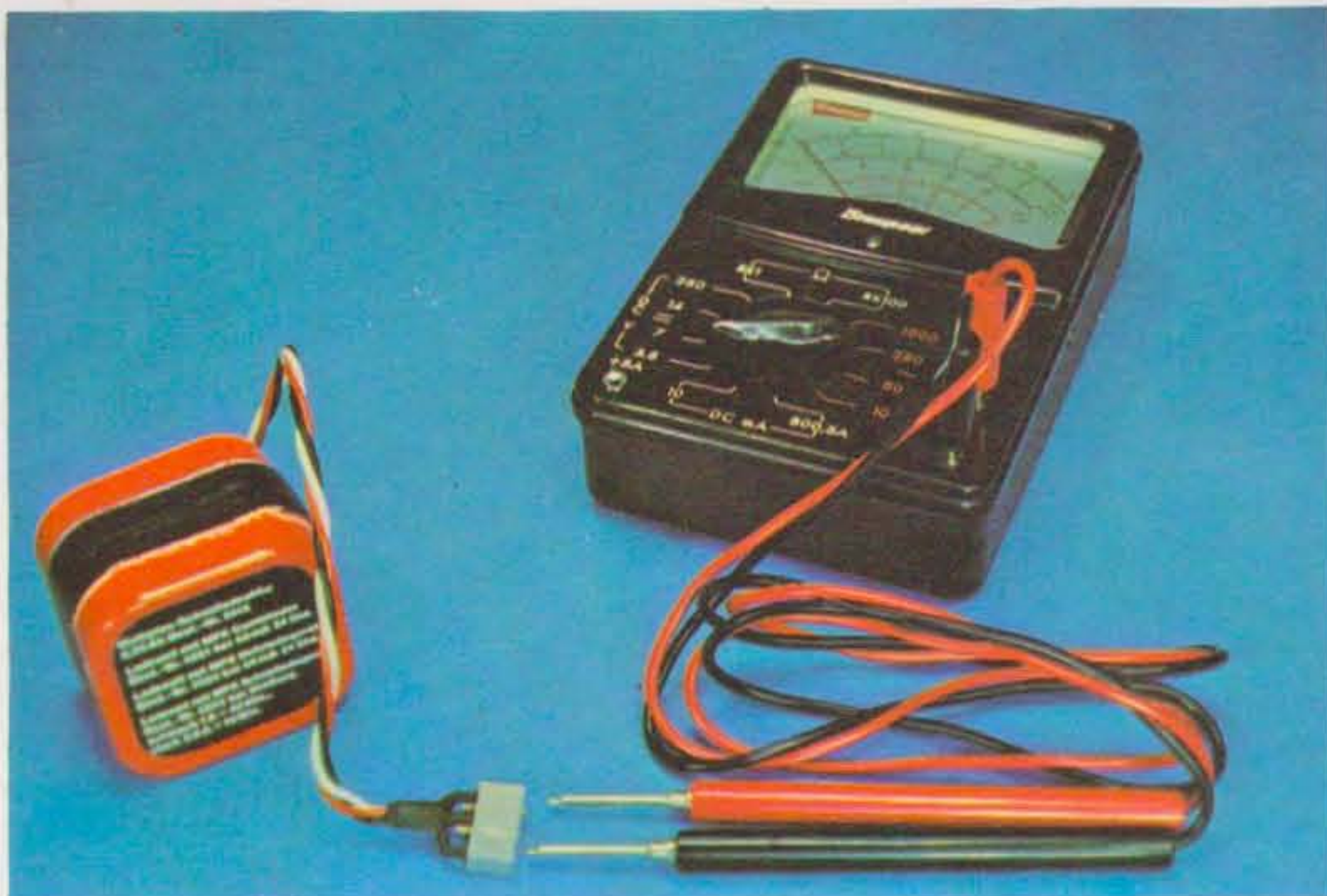
Appareil de mesure Multitesteur pour le contrôle des batteries.
