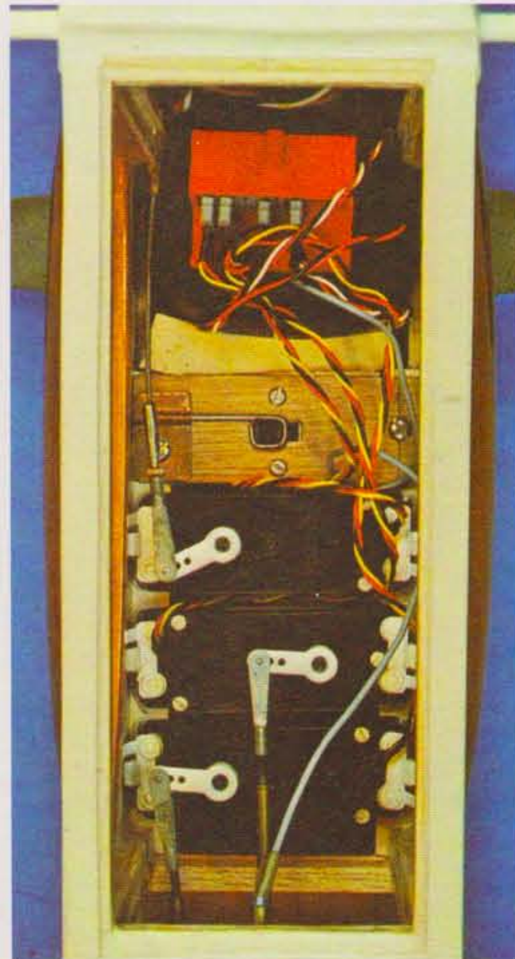
Ci-dessus, à gauche : installation des servos dans un fuselage. Ci-dessus : disposition des trois servos transversalement, l'un derrière l'autre. Ci-dessous : disposition côte à côte des trois servos, avec couplage direction-Train avant.
