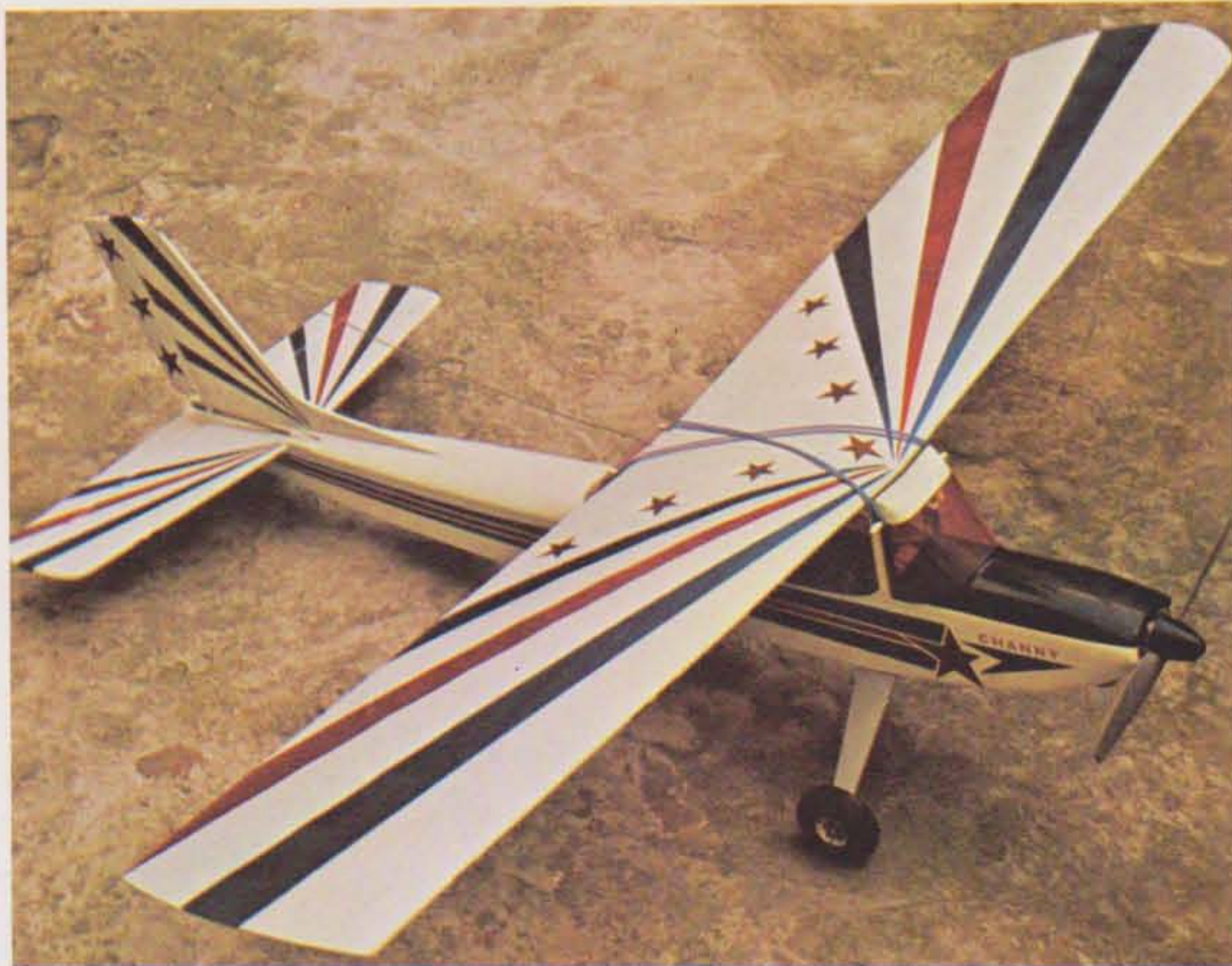
Ci-dessus : avion pour débutant en R/C pour équipement 3 voies et moteurs de 2,5 à 3,5 cm 3 , le « Taxi » (modèle Graupner). Ci-contre : avion pour débutant en R/C pour équipement 3 voies ; moteur 2,5 cm 3 , le « Channy » (Svenson models).
