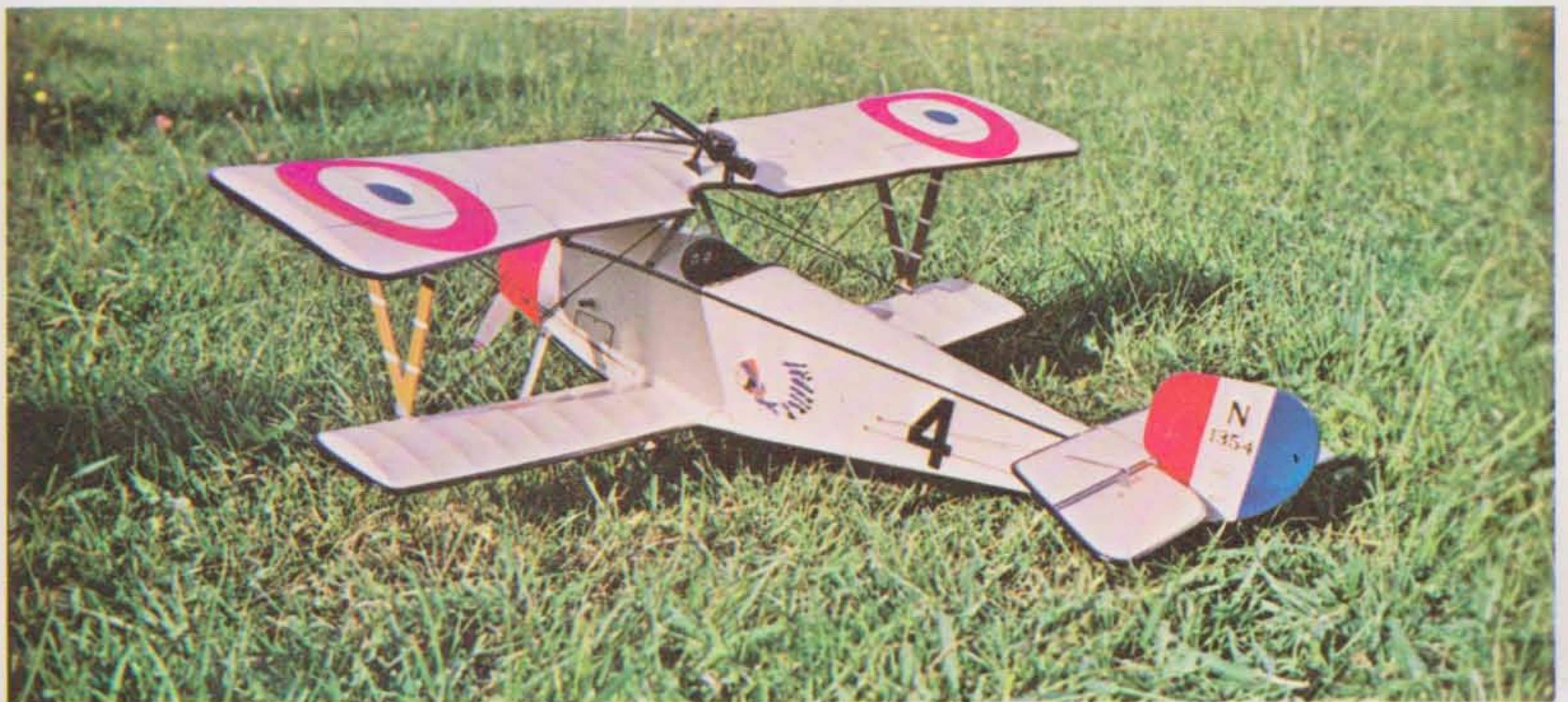
Ci-dessous : une petite maquette motorisée pour le vol libre le « Nieuport 11 »; envergure : 600 mm, moteur Cox 0,3 cm 3 (modèle Guillow's). En bas : maquette de vol libre « Piper Super Cruiser »; envergure : 1 000 mm, moteur Cox 0,8 cm 3 (modèle Jetco).
