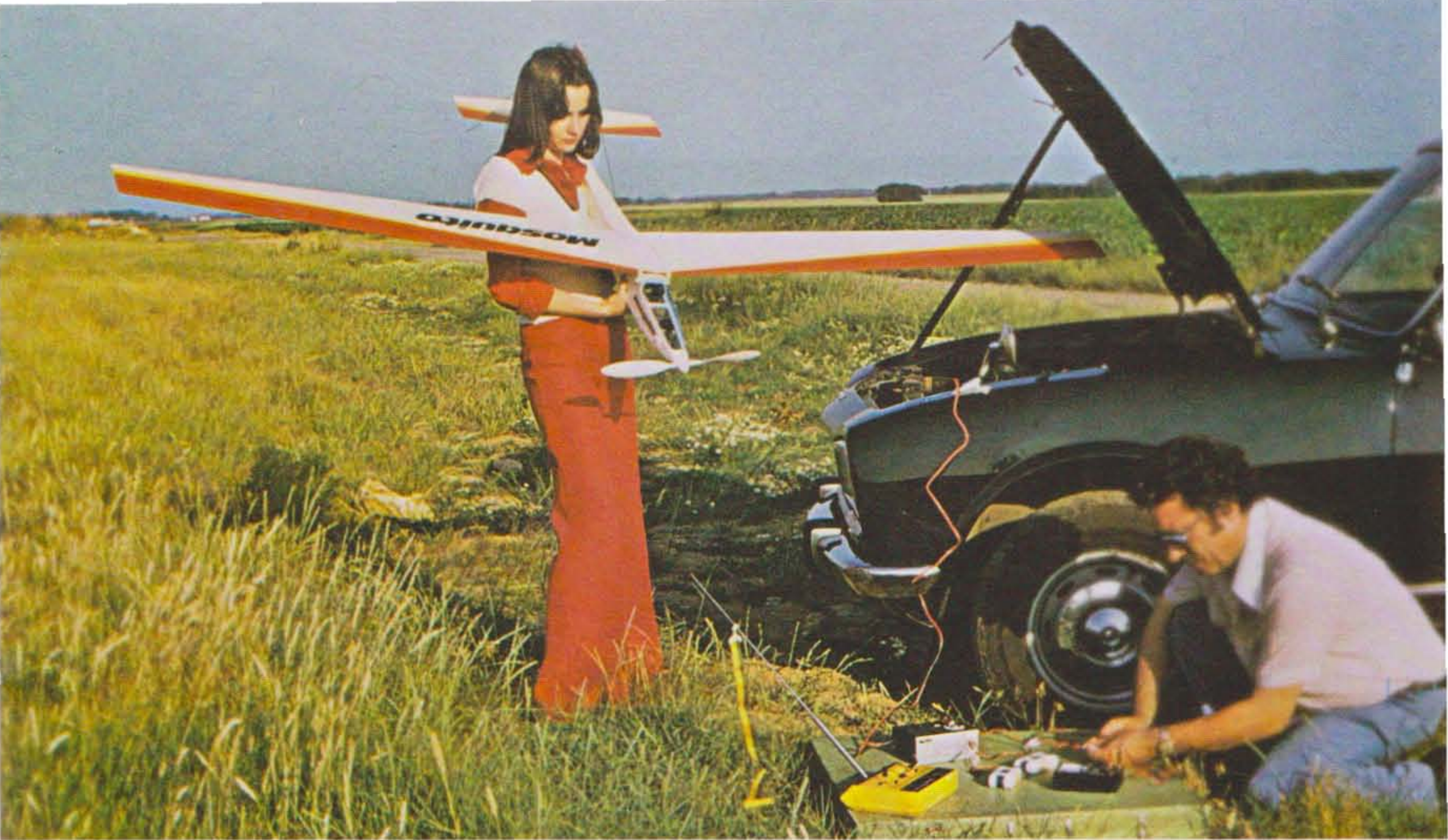
Recharge des batteries du « Mosquito » sur le terrain ; le chargeur est branché sur la batterie 12 V de la voiture.
