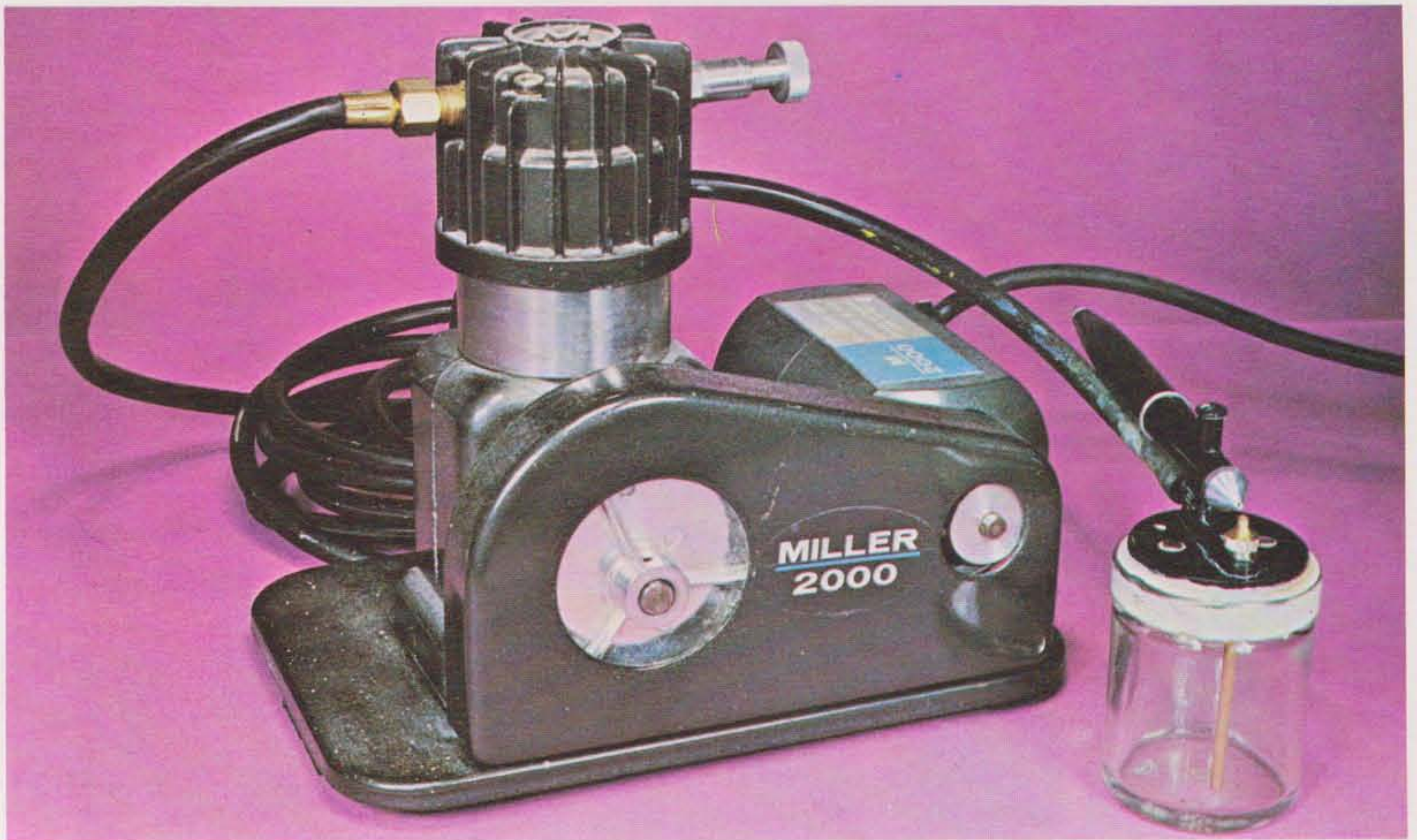
Compresseur et pistolet Miller utilisés pour les gros travaux de peinture et fonctionnant sur le courant secteur.
