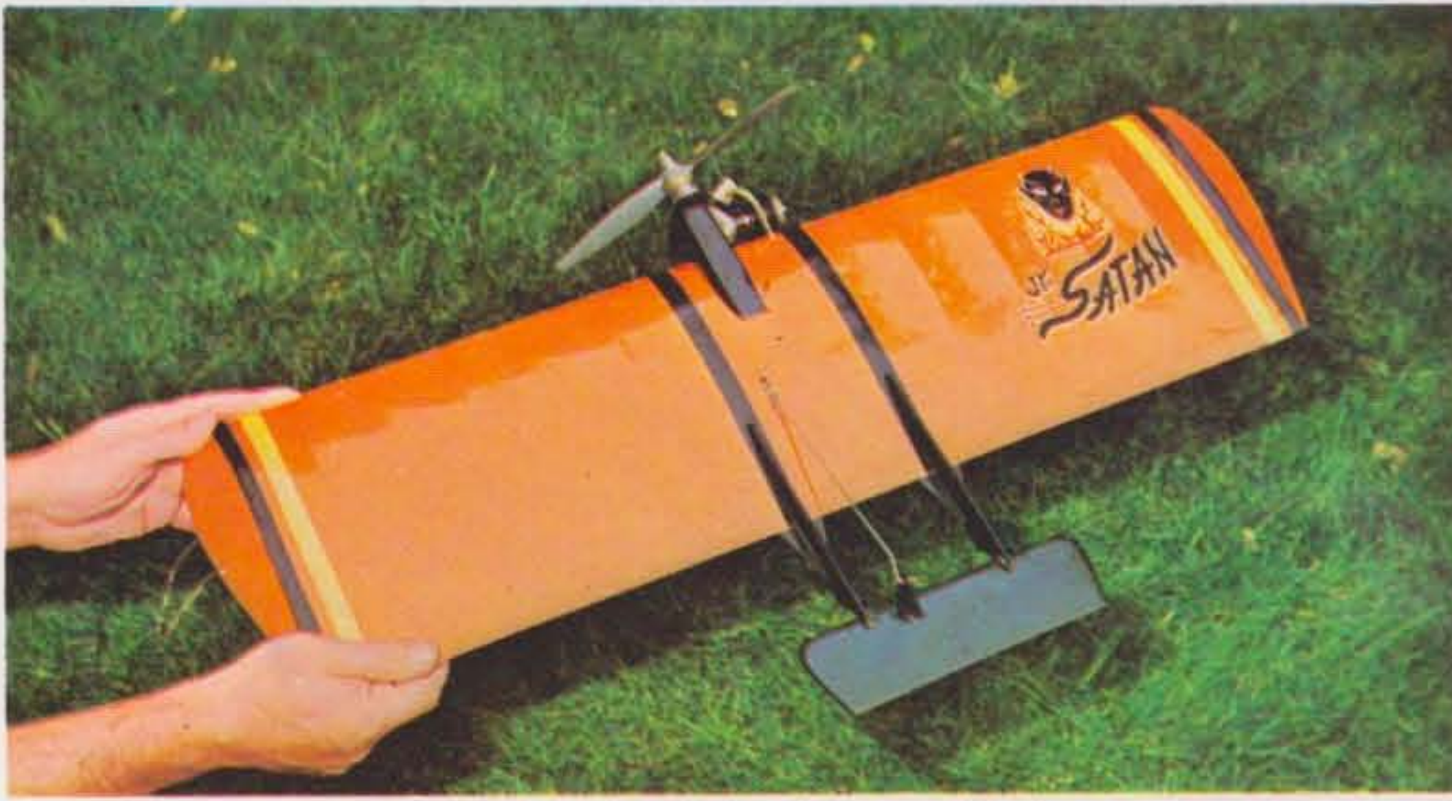
Ci-contre : aile volante de combat « Jr Satan » ; envergure : 730 mm, moteur Cox 2,5 cm 3 (Goldberg models).
