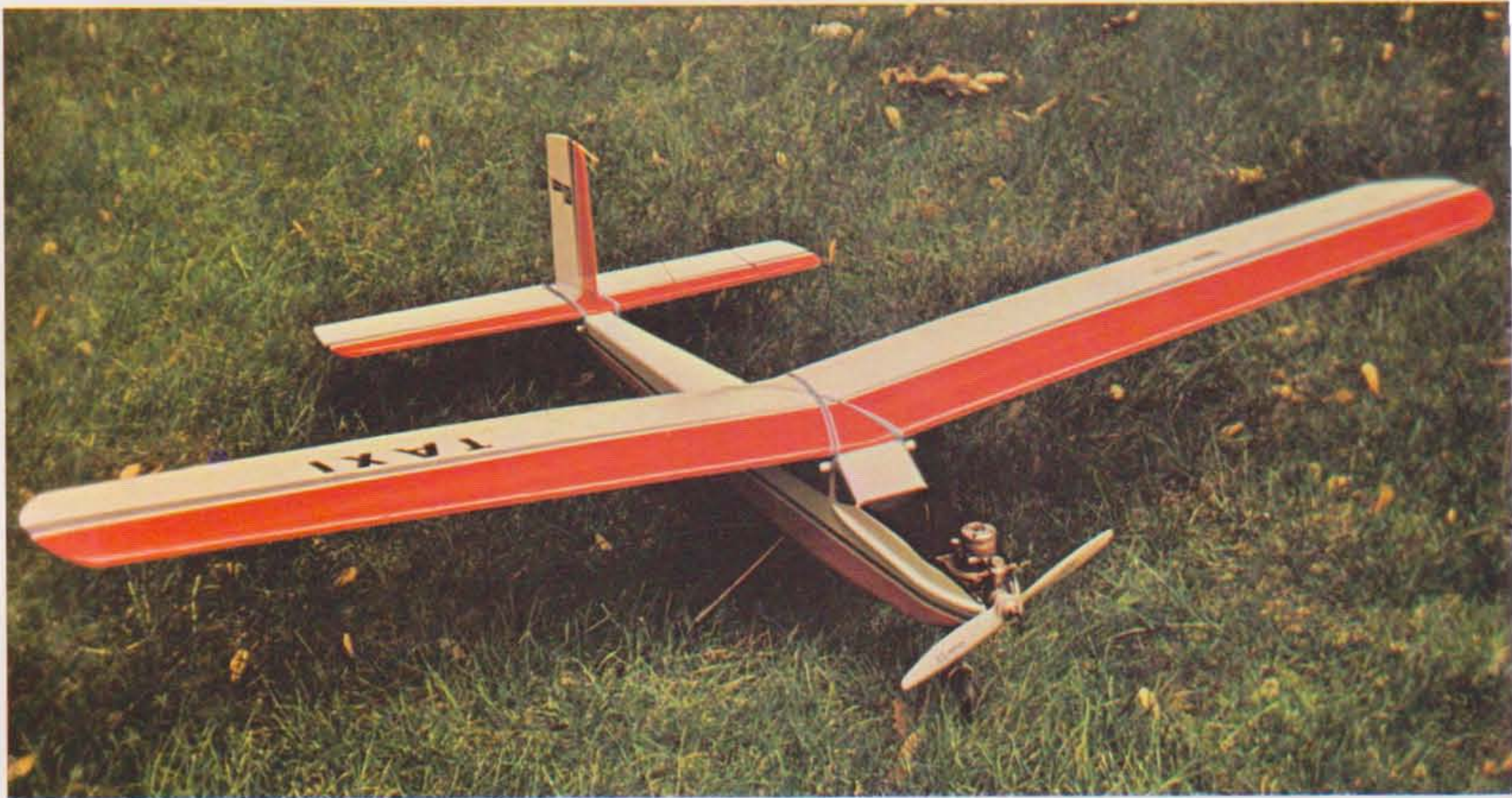
Ci-dessus : avion pour débutant en R/C pour équipement 3 voies et moteurs de 2,5 à 3,5 cm 3 , le « Taxi » (modèle Graupner). Ci-contre : avion pour débutant en R/C pour équipement 3 voies ; moteur 2,5 cm 3 , le « Channy » (Svenson models).
