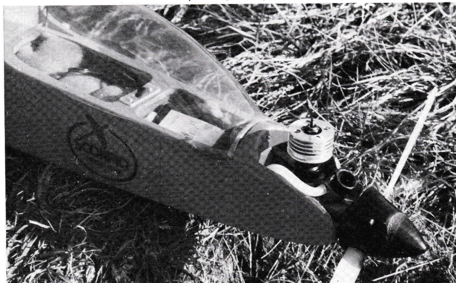
Le moteur recommandé est un Cipolla 1,5 cm 3 , sans carburateur.
