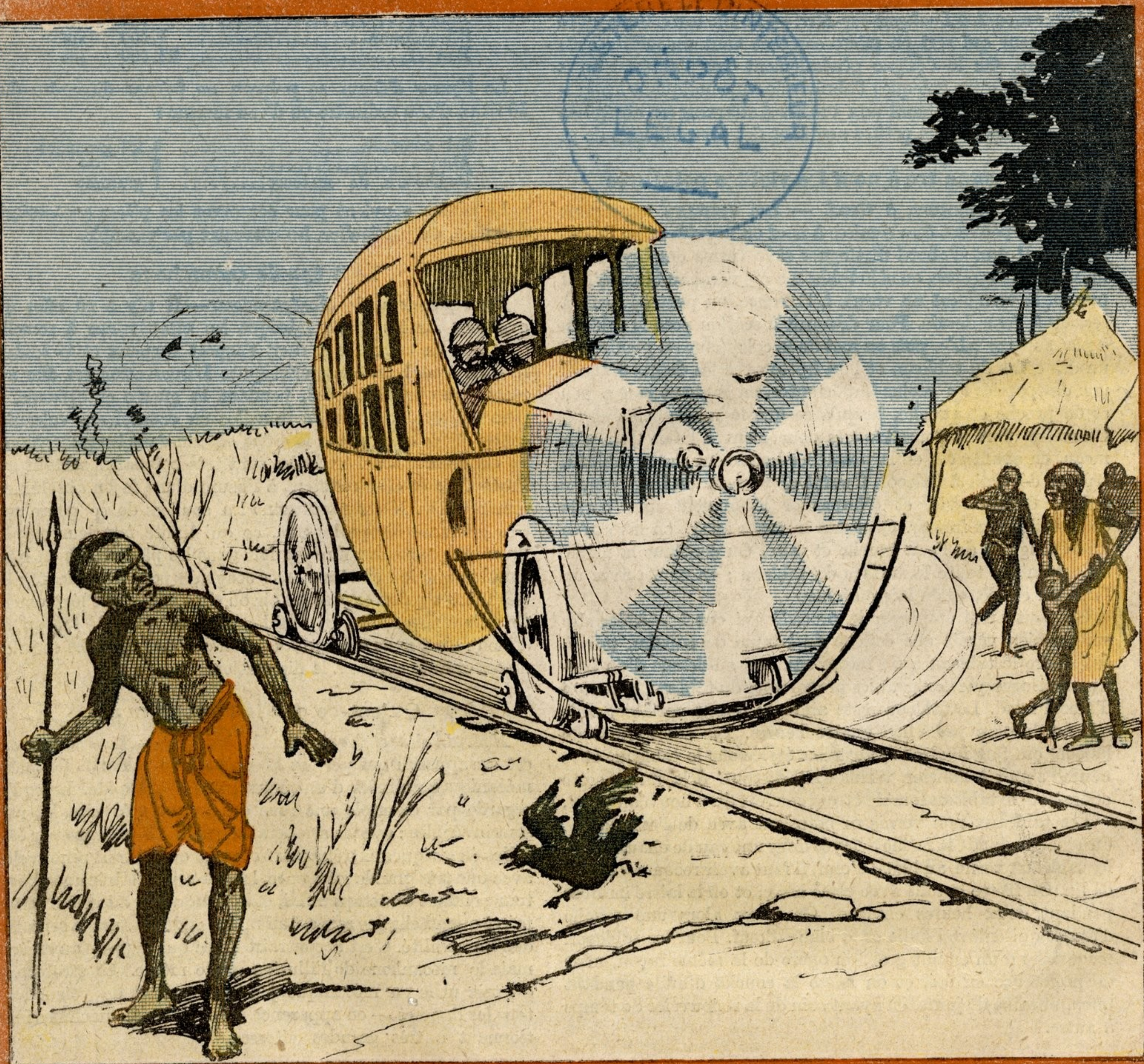
La draineuse à hélice de Leyat, utilisée au Congo français.
