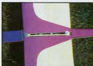
Les ailes sont serrées par ces vis et rondelles.
