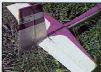
Un tube alu relie les deux demi-profondeurs.
