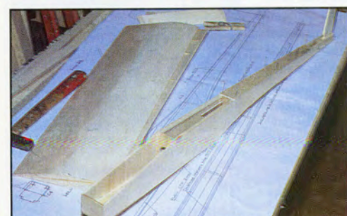
Passez les commandes avant de refermer le fuselage.
