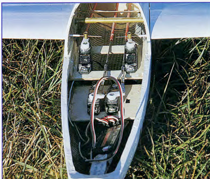
L'équipement radio avec les servos d'ailerons dans le fuselage. On voit la structure monocoque fibrée du fuselage.
