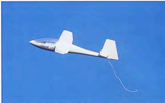
Avec les ailes en version courte, le Cavok a plus l'allure d'un planeur compact d'acro.
