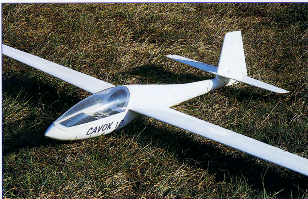
Le monocoque permet de réaliser en balsa un fuselage qui passera pour un modèle en fibre aux yeux des modélistes.
