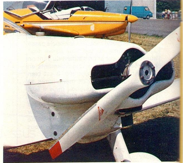
Le Colibri réalisé par Michel Brusset équipé d'un VW de 50 cv ; photos de Jean-Luc Prost.
