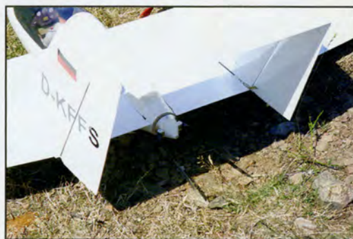
Comme souvent sur les ailes volantes droites, les dérives sont de très grande surface.
