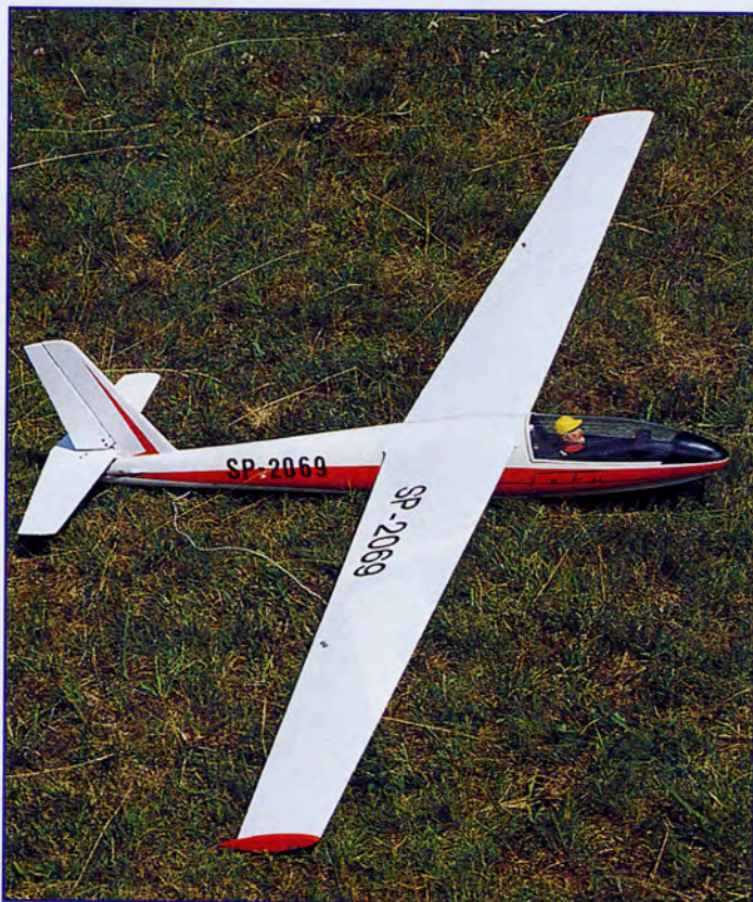
Non, le fuselage n'est pas en fibre : c'est une construction mono-coque en balsa.
