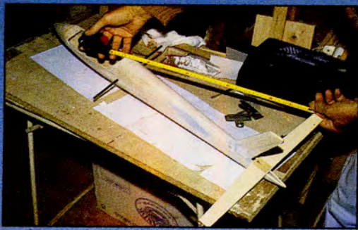
La bonne façon de contrôler la géométrie du stab.
