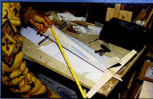
La bonne façon de contrôler la géométrie du stab.
