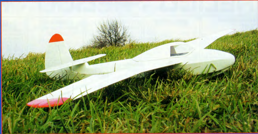
Sur cette vue de trois quarts, on distingue bien la cassure de dièdre.
