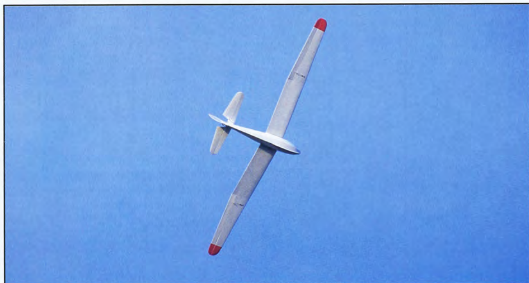
L'aile en mouette est peu prononcée, mais bien présente, une solution toujours très plaisante tant pour l'aspect que pour les qualités de vol.
