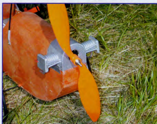
Sous le moteur factice, c'est un GWS 150 réduit 7/1 qui entraîne une hélice 9 x 4,7.
