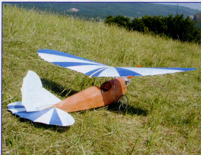
Sagement posé dans l'herbe, le HM 8 dévoile ses surfaces en Dépron.
