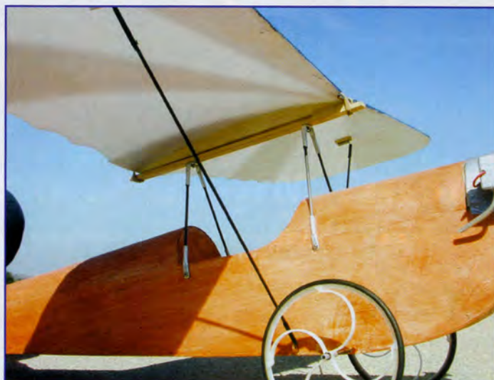
Les haubans sont réalisés en jonc carbone de 2 mm.
