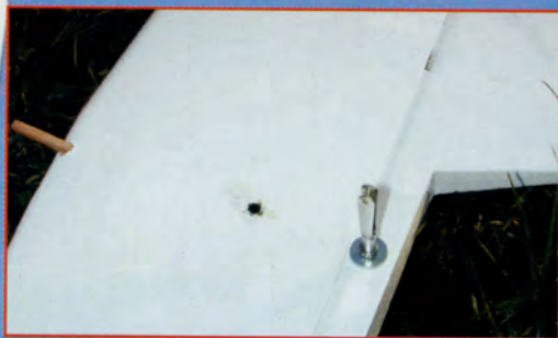
Le guignol du stabilisateur est une grosse chape de 3 millimètres.
