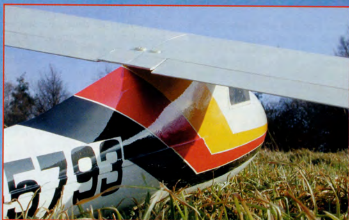
Les apparences sont trompeuses, et le fuselage est en bois, construit selon la technique du monocoque sur couples.
