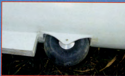
La roue est montée sur des supports en CTP, venus de construction.
