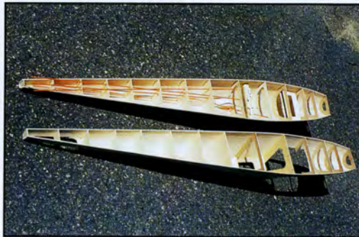
Le fuselage monocoque est réalisé en deux parties, haute et basse.
