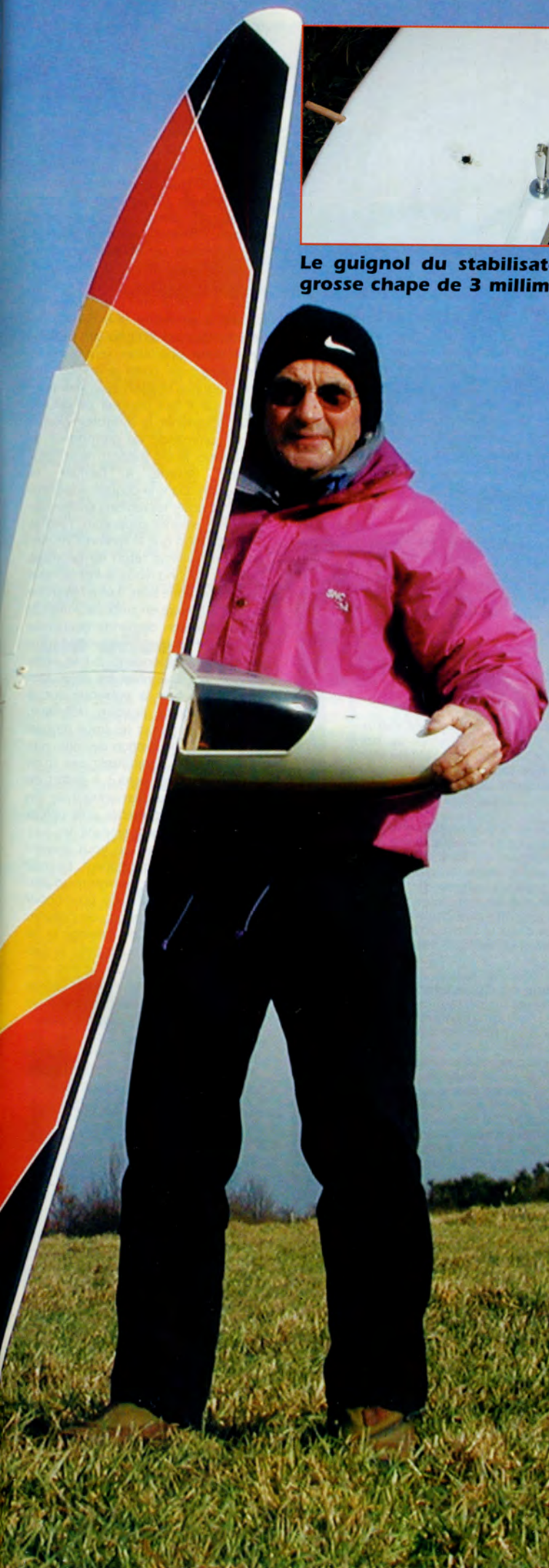
Les apparences sont trompeuses, et le fuselage est en bois, construit selon la technique du monocoque sur couples.
