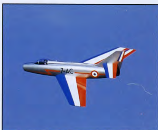
PSS ou jet, le Mystère 4 vole sage-ment, grâce au profil Eppler 205 de l'aile.
