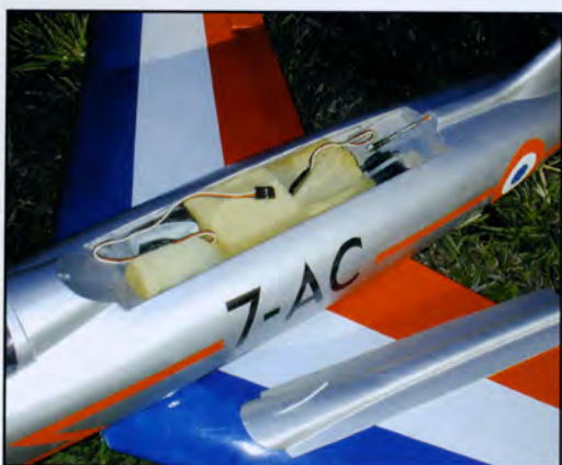
Dans la version planeur, l'accu de réception et le récepteur trouvent place sous le capot supérieur.
