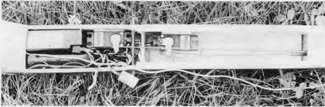
L'installation radio du prototype de gauche à droite : le récepteur, puis les servos de direction et profondeur avec leurs tringleries.
