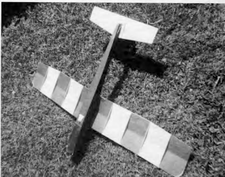
Le dessous du modèle laisse parfaitement apparaître le profil Jedelsky.
