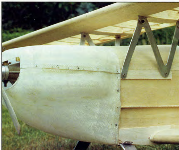
Le capot a été réalisé en fibre sur moule perdu. Il est également possible de le trouver thermo-formé chez Euberlay Modélisme. On voit bien également la cabane en dural.
