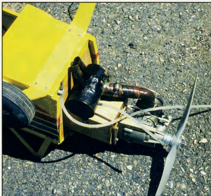
Deux vues de l'installation du moteur, et du pot d'échappement réalisé de toutes pièces pour s'intégrer dans le capot.
