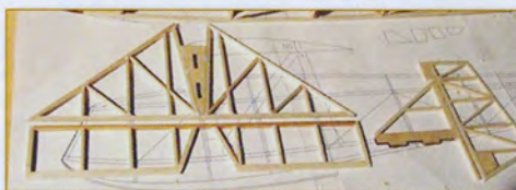
Les empenages en treillis. Attention, la baguette de jonction des demi-profondeur est en pin.
