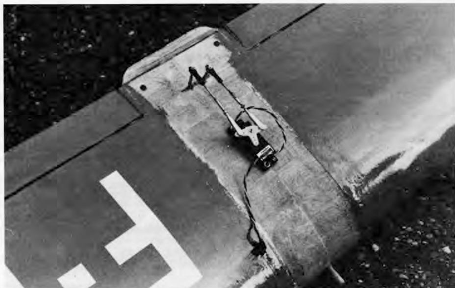
La partie centrale de l'aile, sa fixation, les ailerons full-span et leur servo.
