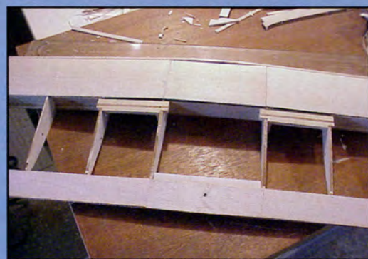
Assemblage des demi-ailes et mise en place des supports de train.
