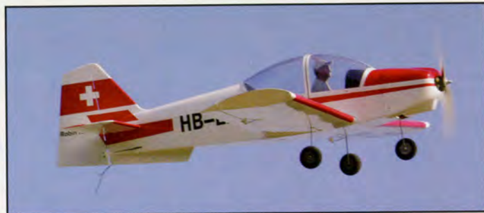
Une vue qui montre parfaitement la sous dérive caractéristique du 2160 et qui le distingue au premier coup d'œil d'un HR 200.
