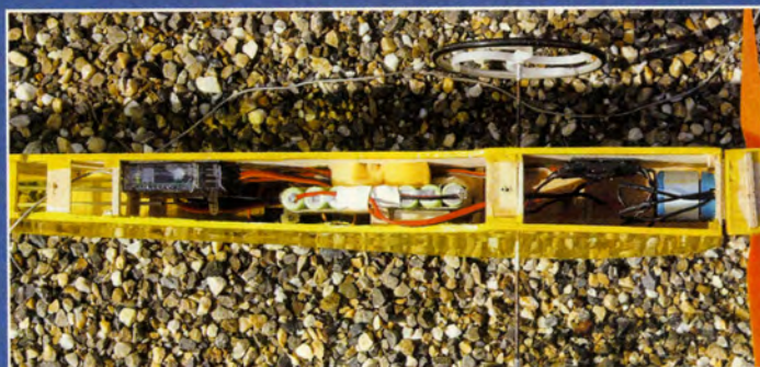
Installation radio sur Achille : tout est dans le fuselage.
