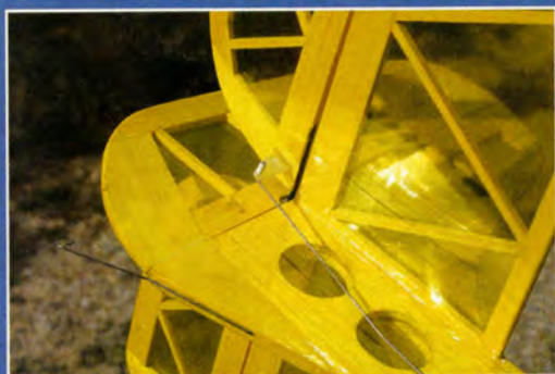
Les commandes sur Achille et la structure ultra légère mise en valeur par le revêtement transparent.
