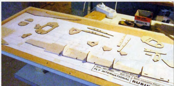
Montage des couples sur la plaque de base.
