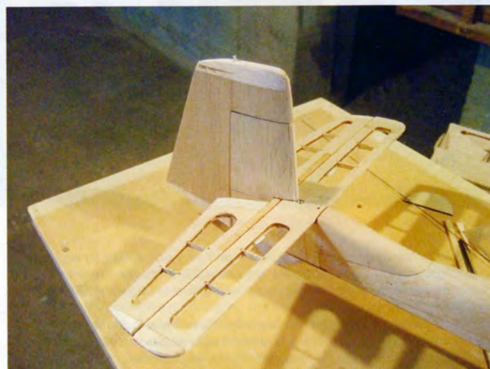
La partie arrière avant entoilage.
