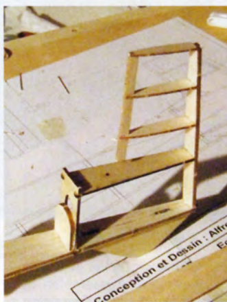
La dérive fixe en cours de montage.
