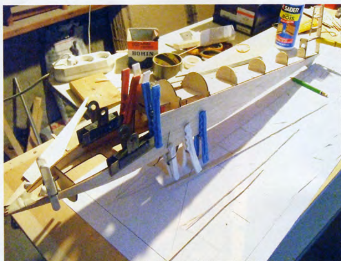
Coffrage du fuselage.
