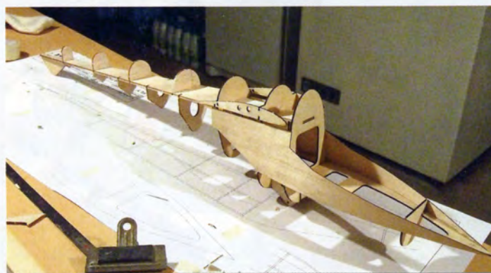
Le fuselage avant coffrage.
