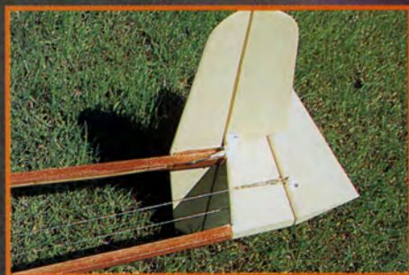
On voit la commande de profondeur par gaine qui suit la poutre du fuselage.
