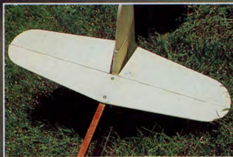
La profondeur est construite en treillis, à l'image du vrai.
