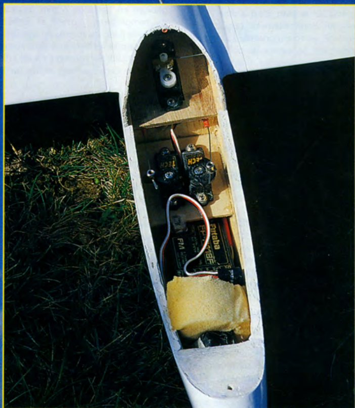
L'installation radio dans le fuselage en balsa monocoque.
