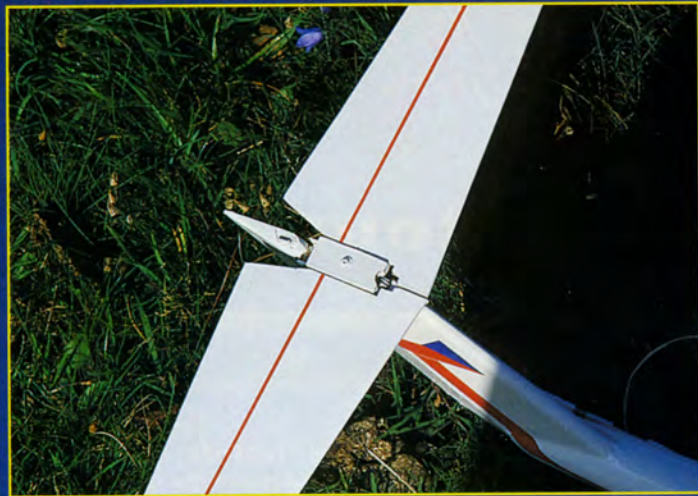
L'empennage en T est monobloc. On aperçoit ici la commande.
