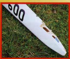
Ci-dessus : la dérive a été rendue démontable pour faciliter le transport. Vous noterez également que le fuselage monocoque, recouvert de fibre de verre intérieur-extérieur, ne possède pas beaucoup de couples dans sa partie avant : l'aménagement cabine est possible.
