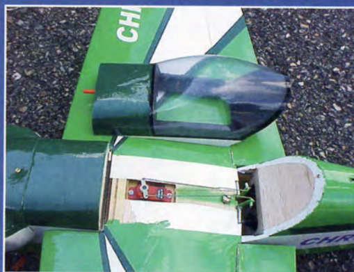
Le servo d'ailerons, accessible sous la bulle, et on note le verrou de cette verrière.
