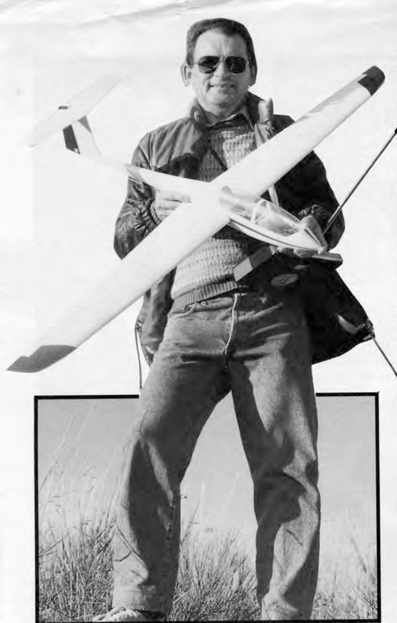
Malgré sa petite taille, le G 103 possède une bonne surface alaire, qui lui donne des qualités de vol exceptionnelles pour un modèle de cette envergure. Ci-dessus : à noter la verrière qui s'ouvre à l'aide d'une petite corde à piano passant dans le trou du crochet.
