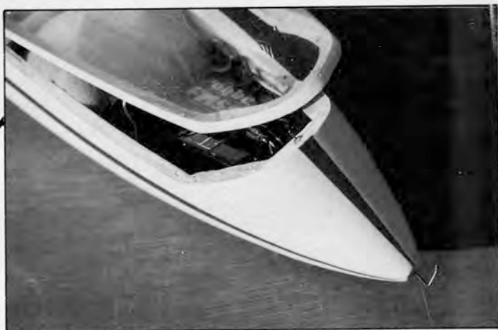
Malgré sa petite taille, le G 103 possède une bonne surface alaire, qui lui donne des qualités de vol exceptionnelles pour un modèle de cette envergure. Ci-dessus : à noter la verrière qui s'ouvre à l'aide d'une petite corde à piano passant dans le trou du crochet.
