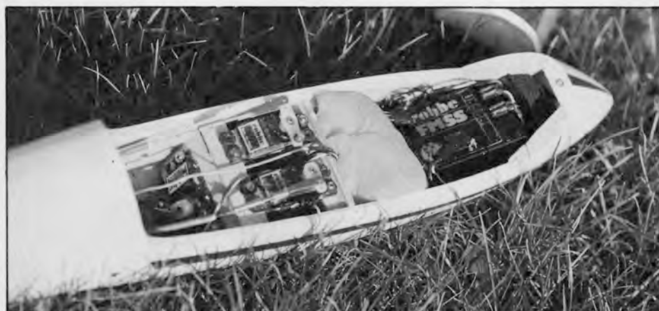
Ne cherchez pas l'accu, il est sous les servos ! En revanche, pas un gramme de plomb pour arriver au bon centrage !
