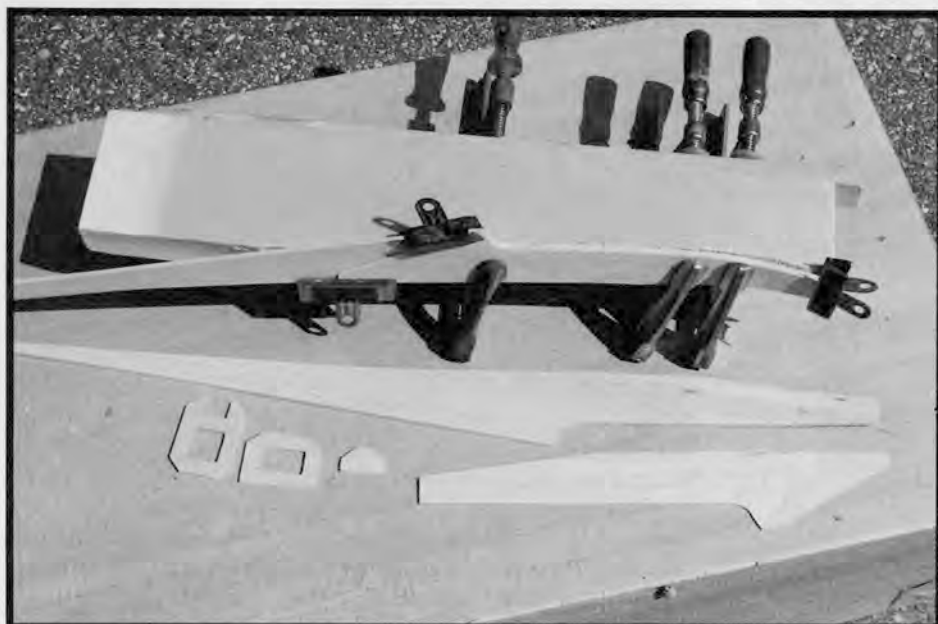
La manière de cintrer les flancs avec un bloc de roofmate et des serre-joints.
