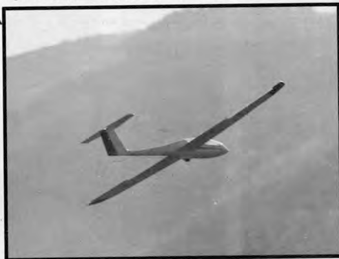
Malgré sa petite taille, le G 103 possède une bonne surface alaire, qui lui donne des qualités de vol exceptionnelles pour un modèle de cette envergure. Ci-dessus : à noter la verrière qui s'ouvre à l'aide d'une petite corde à piano passant dans le trou du crochet.
