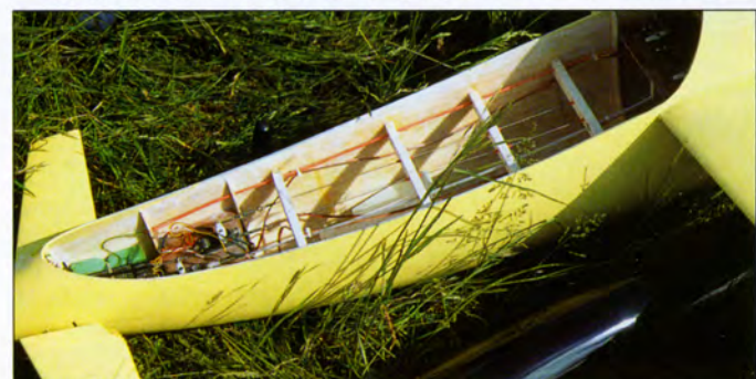
Verrière déposée, vous pouvez jeter un œil à l'intérieur du volumineux fuselage. Celui-ci est construit par la méthode du monocoque, en deux demi-coquilles droite et gauche. Sur l'appareil jaune, les couples ont été en partie retirés pour faciliter le raccordement des deux moitiés de fuselage, un fin tissu de verre collé intérieurement à l'époxy venant renforcer la structure.
