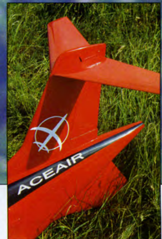
Gros plan sur le stabilisateur en Té à forte flèche arrière qui constitue, avec le plan canard de l'avant, l'une des signatures de cet aéronef.
