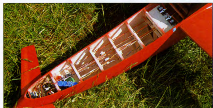
Verrière déposée, vous pouvez jeter un œil à l'intérieur du volumineux fuselage. Celui-ci est construit par la méthode du monocoque, en deux demi-coquilles droite et gauche. Sur l'appareil jaune, les couples ont été en partie retirés pour faciliter le raccordement des deux moitiés de fuselage, un fin tissu de verre collé intérieurement à l'époxy venant renforcer la structure.
