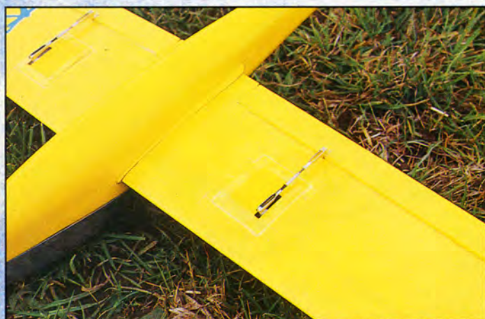
Les servos d'ailerons sont intégrés dans les ailes.
