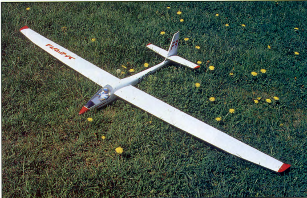
Un fuselage bois peut être très arrondi et beaucoup le prennent pour une fuseau fibre.
