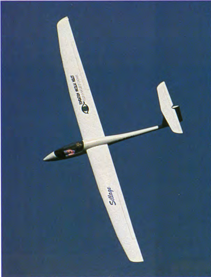
Totalement polyvalent, le Sillage excelle dans l'exploitation des thermiques grâce à ses profils HQ très porteurs.
