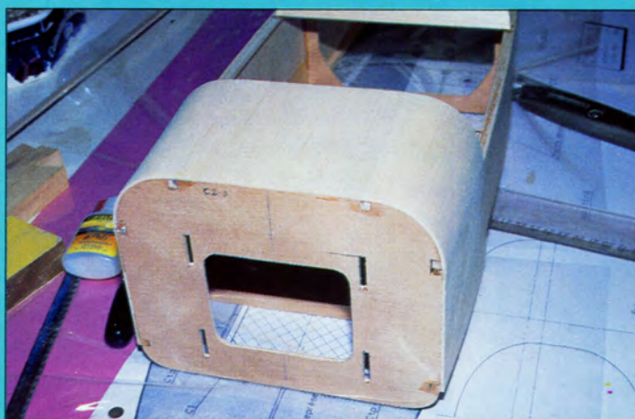
5 - Coffrer en balsa 20/10 le dessus du fuselage.
