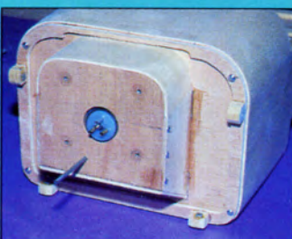
17 - Découper le faux couple de centrage sur lequel sont collés les plots de fixation du capot.
