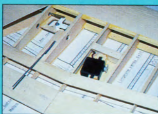
30 - Retourner les demi-ailes et confectionner une cale évitant le vrillage à positionner sous la nervure n° 9. Coffrer le dessous comme le dessus.
