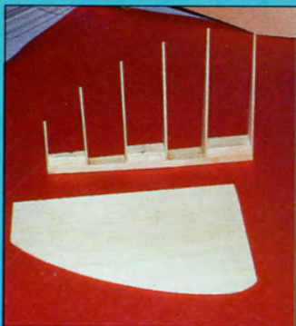
10 - Monter la structure de volet mobile et préparer les coffrages en balsa léger.
