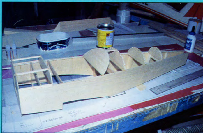
4 - Coller les faux couples supérieurs aux endroits requis.
