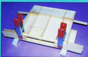
34 - Découper les clés d'aile en Ctp et les ajuster ensemble.
