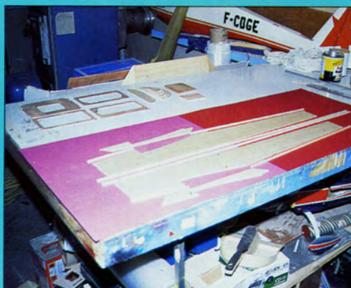
2 - Coller les renforts internes des flancs et les baguettes d'angles.
