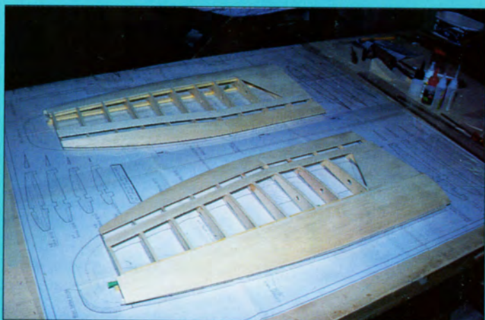
29 - Coffrer le reste de l'aile en balsa 15/10 et poser les chapeaux de nervures.
