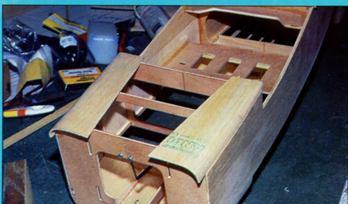
6 - Rouler le coffrage inférieur en balsa 15/10
