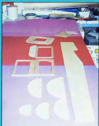
1-Découper les flancs et les couples suivant le plan.
