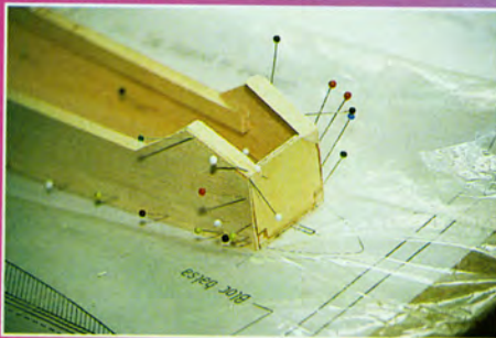
2- Coller sur les flancs et le fond du fuselage les baguettes de renfort. Sur le fond, coller également les deux couples en contreplaqué.
