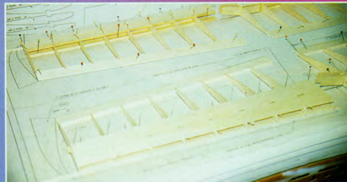
17- Coller les nervures de jonction entre le panneau d'aile rectangulaire et le panneau trapézoïdal.
