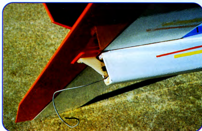
La commande de profondeur est bien protégée.
