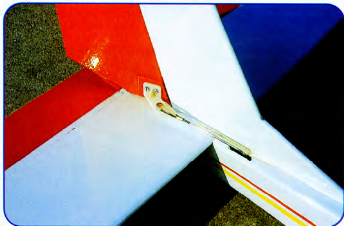
Sortie de la commande de direction.
