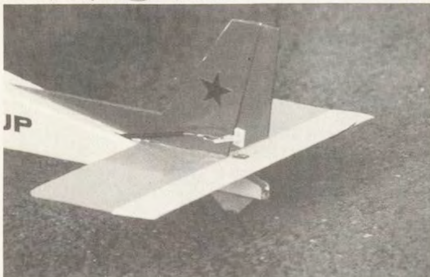
Le centre de l'aile est légèrement renforcé, mais toujours sans coffrage. Les empennages de type "planche".
