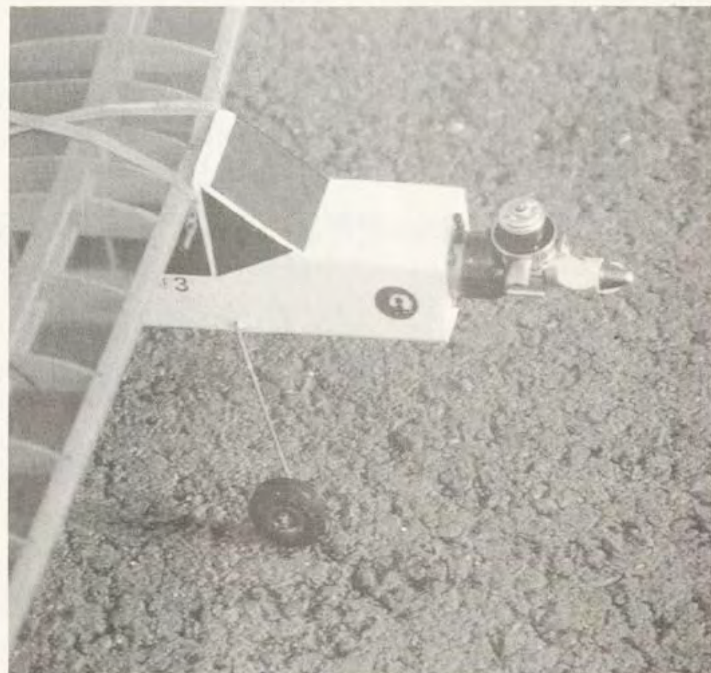
Le moteur n'est pas caréné, ce qui facilite la "maintenance".
