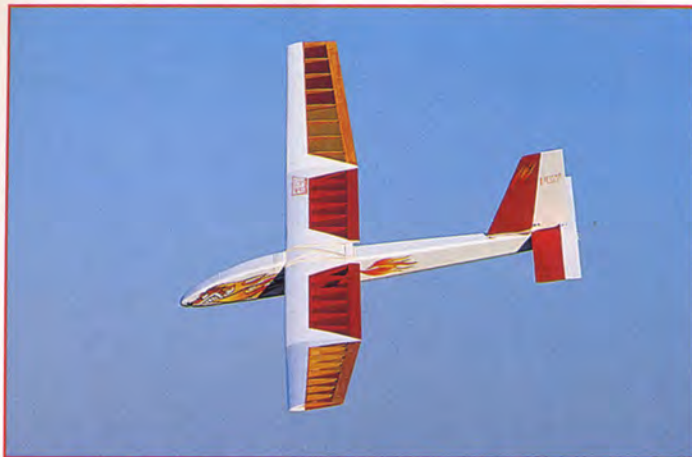
Aile deux axes "perfo", plus pénétrante, plus maniable, elle permet de se perfectionner et de traquer les thermiques.
