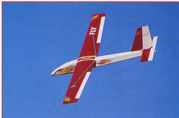
Aile trois axes, pour apprendre le pilotage aux ailerons, la conjugaison ailerons-direction, et aussi les bases de la voltige.
