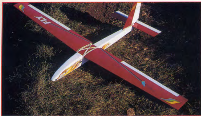
Le Golf Tango trois axes possède une aile en trapèze simple à faible dièdre et des ailerons profonds.
