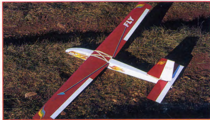
Le Golf Tango trois axes possède une aile en trapèze simple à faible dièdre et des ailerons profonds.
