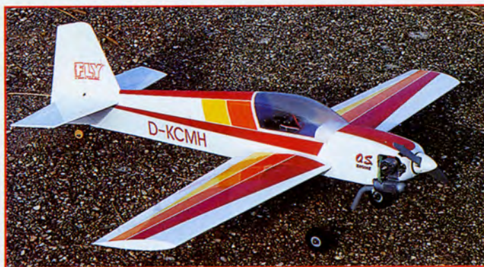
Le moteur s'intègre bien dans le capot et le pot reste discret.
