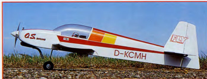
Le haut fuselage facilite les tonneaux lents.
