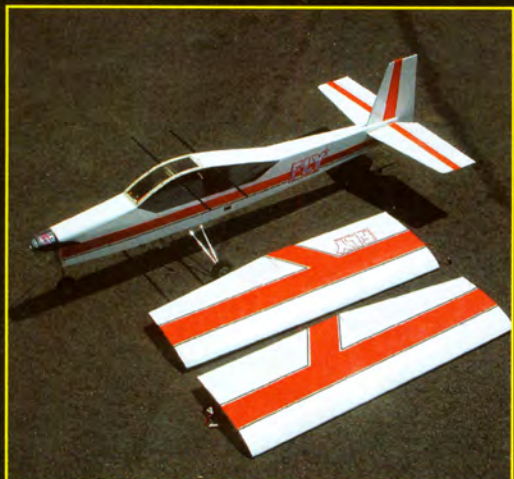
L'Hélairka Trainer possède une aile démontable en deux parties, pratique pour le transport !
