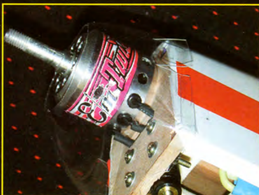
Le Twister 19 se visse directement sur le couple avant. Le capot laissé transparent : c'est pour la promo !
