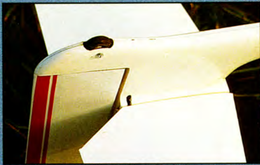
Le sabot arrière protège la dérive et permet de monter une roulette.
