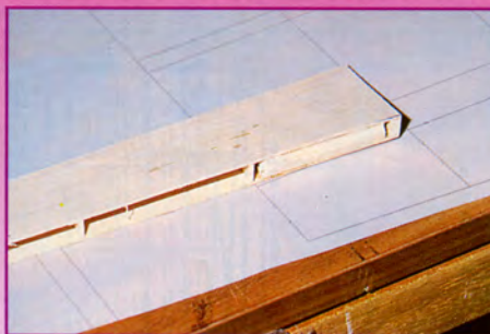
27 - Dans l'aileron, placez un bloc de renfort là où sera placé le guidon.
