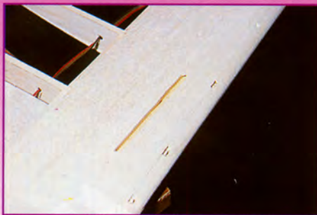
26 - Dégagez la rainure pour le train et percez le trou Ø4 mm.
