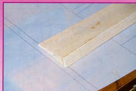
28 - Refermez l'aileron à l'aide de balsa de 5 mm et réalisez le biseau. Vous avez tous les éléments qu'il reste à entailler.
