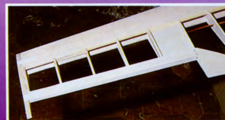
25 - Découpez l'aileron et refermez la découpe avec un balsa de 3 mm.
