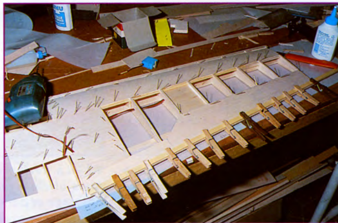
23 - Après séchage 24 heures, retourner l'aile et changer les cales de bord de fuite. Plaquer un côté sur le chantier et coffrez le.
