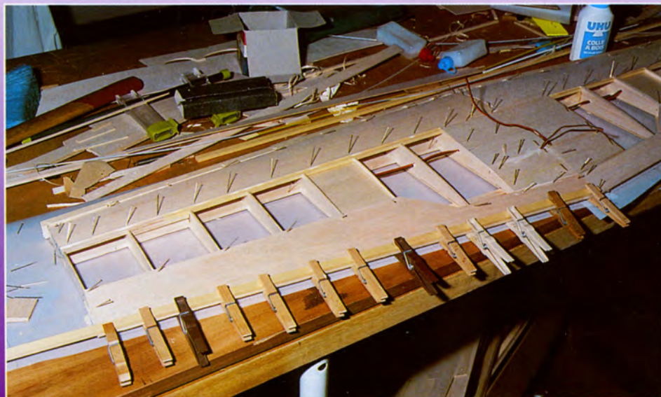
22 - Coller des blocs de bois dur contre le bord d'attaque au centre pour renforcer le passage des touillons de fixation d'aile.
