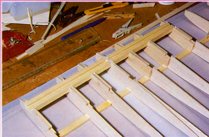
17 - Coller les baguettes rainurées support de train.
