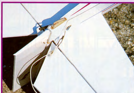
28 - Refermez l'aileron à l'aide de balsa de 5 mm et réalisez le biseau. Vous avez tous les éléments qu'il reste à entailler.
