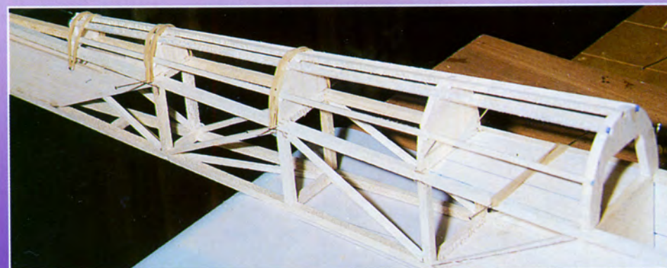
7 - Collez les faux couples du dos de fuselage et les lisses en 3 x 3 balsa (seulement !).
