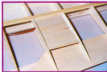
21 - Coller la platine support de servo entre deux nervures.
