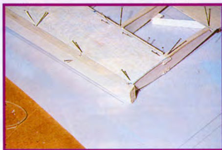
20 - Coller le bord d'attaque après avoir réalisé les encoches.
