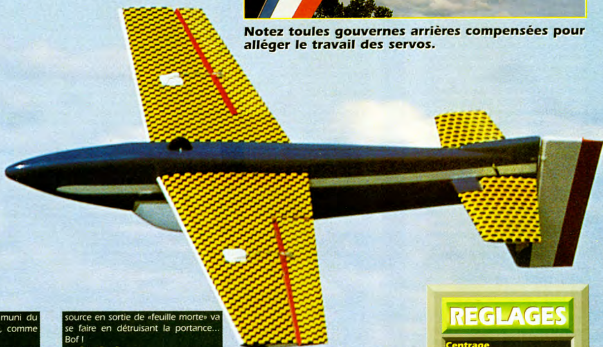
La surface latérale est énorme pour favoriser la portance latérale.
