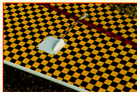
Le servo d'aileron est monté sur un cache Promodel.
