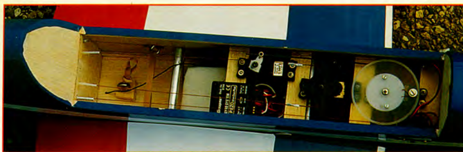
Installation radio : à l'avant, le servo de profondeur avait encore le système à poulie. On a depuis remonté une commande rigide.
