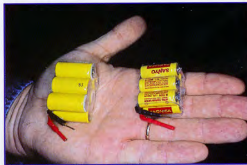
Les deux types d'accus : 150 ou 270 mAh pour 5 ou 10 minutes de vol.
