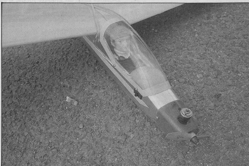
quatre vis M2,5 et écrous nylstop. La bulle est vissée sur le fuselage de même que le capot.
