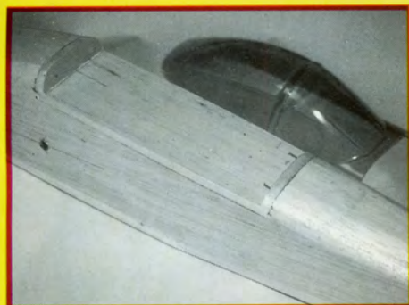
7 - Après avoir poncé le fuselage, fabriquez un baquet de verrière en balsa.
