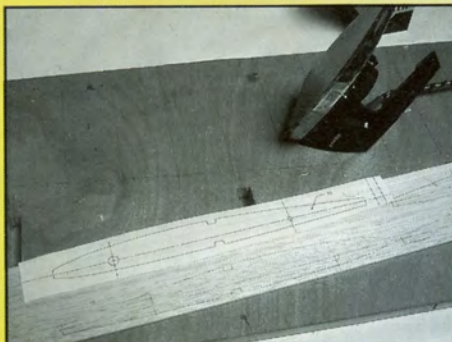
8 - Pour reporter les nervures sur le balsa, utilisez une photocopie (format A3) et un fer à repasser. L'encre se dépose sur le bois.
