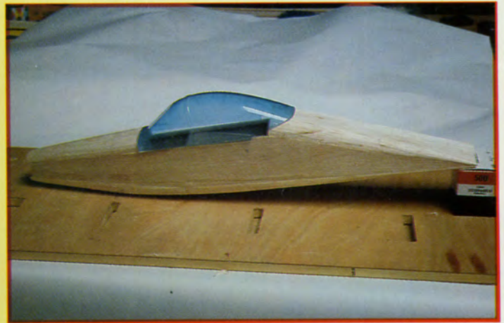
6 - Gros travail au rabot pour approcher la forme du fuseau qui sera poncée ensuite. Utilisez la bulle pour donner la forme au dessus du fuseau.
