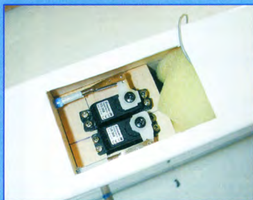
Deux servos seulement suffisent pour le pilotage du Sweet Trainer.
