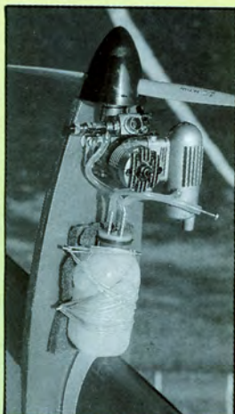
Le réservoir est monté à l'aide de bracelets caoutchouc.
