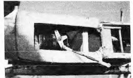
La profondeur est commandée par une barre rigide, équipée de rotules.
