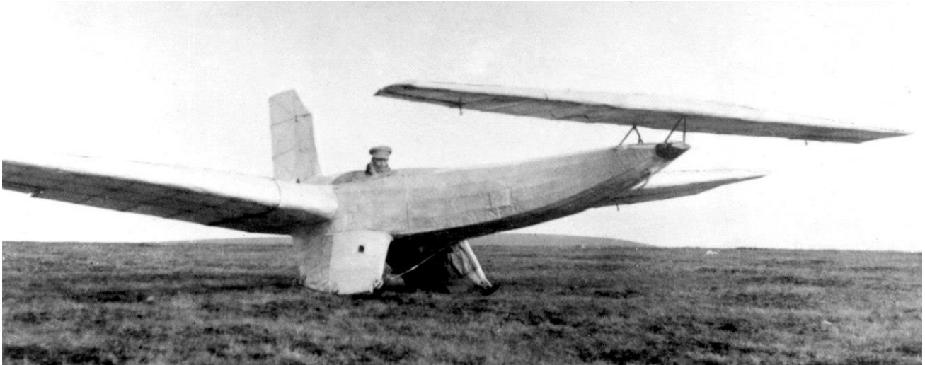
Die Aachener FVA-3 „Ente“ auf der Wasserkuppe 1922. Gut zu erkennen ist die filigrane Lagerung des Vorderflügels, die nicht nur eine Auf- und Abbewegung sondern auch ein seitliches Kippen zuließ. (Sammlung DEHLA)
