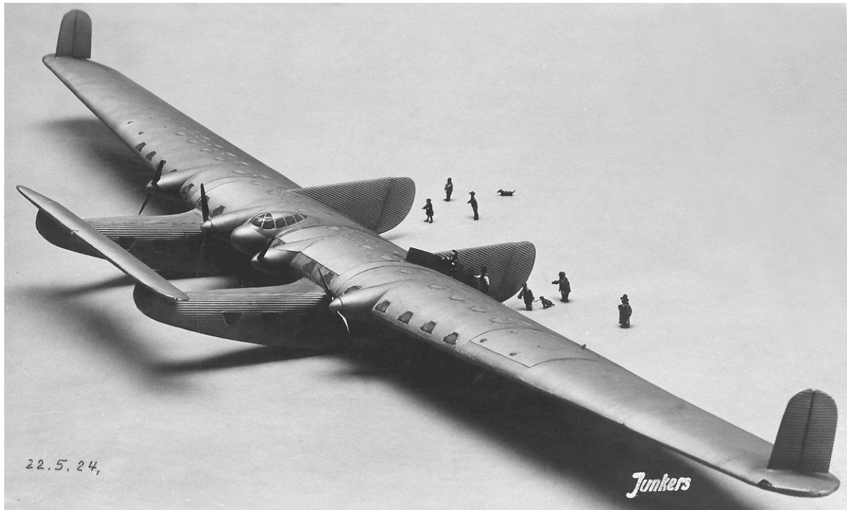
Modell des Junkers-Projekts J 1000, eines riesigen Passagierflugzeugs in Entenbauweise
