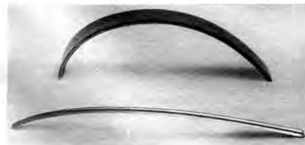
Abb. 2. Biegeschablone für Profilbänder und fertiges Profilband.
