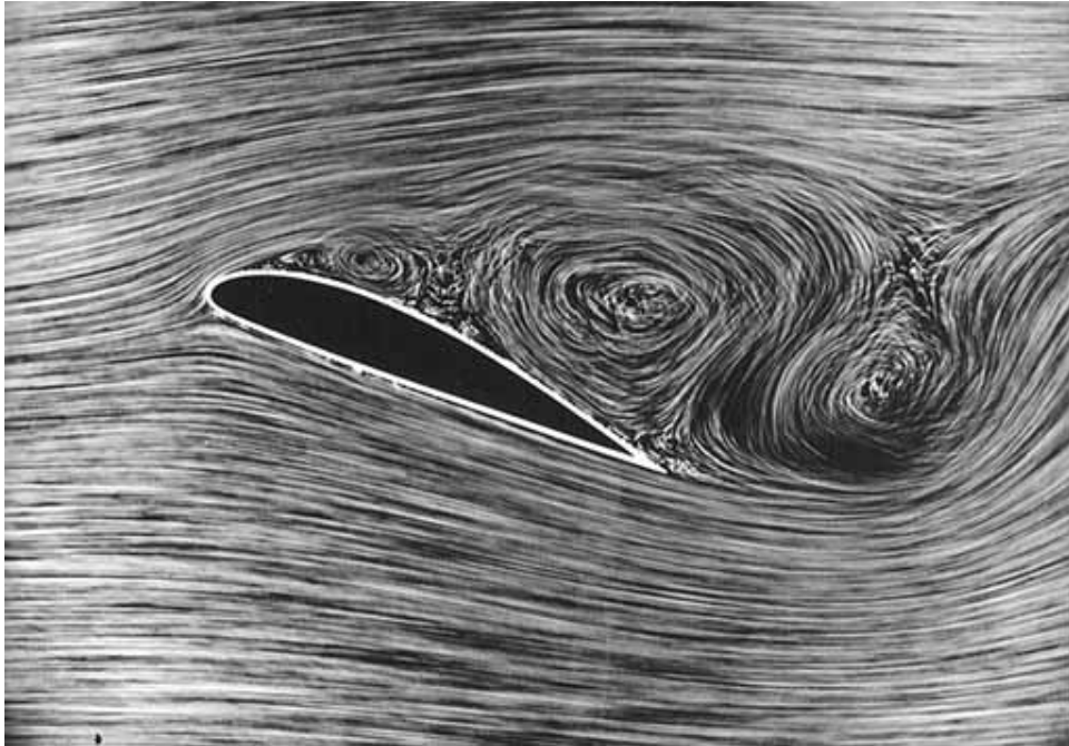
Profil à incidence supérieure à l'angle de décrochage
