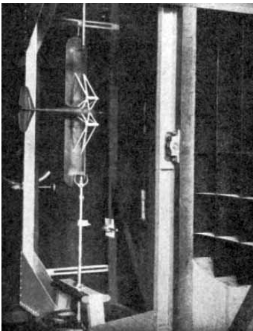
Etude en soufflerie du comportement d'un modèle sur son axe de tangage.
